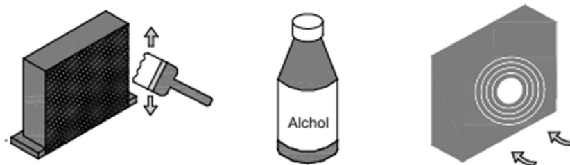
Bild 6 Reinigung des Kondensators
