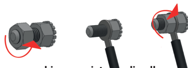
Figura 3: Collegamento dell'apparecchio a un sistema di collegamento elettrico equipotenziale.
