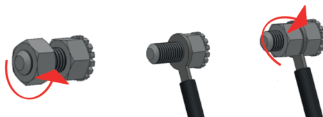
Bild 3. Der Anschluss des Gerätes an die Potentialausgleichsanlage
